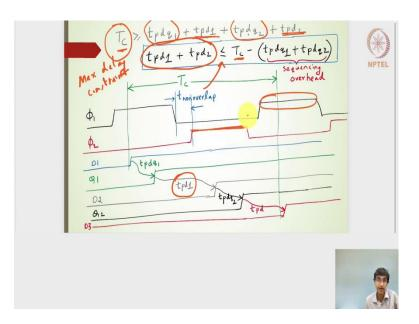
$T_c \ge t_{pdq1} + t_{pd1} + t_{pdq2} + t_{pd2}$
