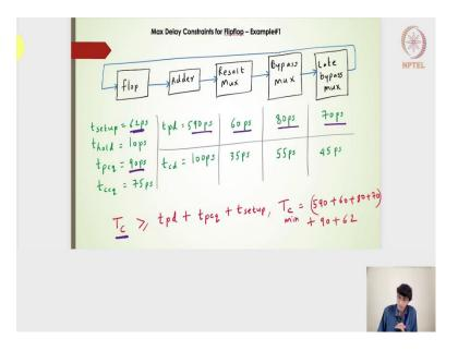
$$T_{c} \ge t_{pd} + t_{pcq} + t_{setup}$$
