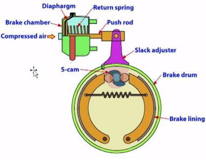
**BRAKE CHAMBER FOR DRUM BRAKE**
