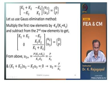
$$\begin{bmatrix} K_1 + K_2 & -K_2 \\ -K_2 & K_2 \end{bmatrix} \begin{bmatrix} u_2 \\ u_3 \end{bmatrix} = \begin{bmatrix} 0 \\ p \end{bmatrix}$$
