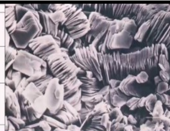
Crystals of clay mineral (Kaolinite) under SEM
