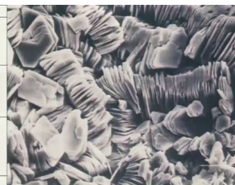
Crystals of clay mineral (kaolinite) under SEM
