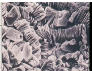
Crystals of clay mineral (Kaolinite) under SEM
