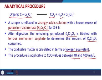
Organic C + Cr<sub>2</sub>O<sub>7</sub> $\rightarrow$  CO<sub>2</sub> + H<sub>2</sub>O + Cr<sub>2</sub>O<sub>4</sub><sup>2-</sup>
